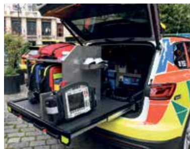
ZÁSTAVBA vozidla zároveň umožňuje vhodnější uložení zdravotnického vybavení, například přístroje LUCAS, který slouží pro automatické stlačování hrudníku pacientů při resuscitaci. Foto: MHMP
